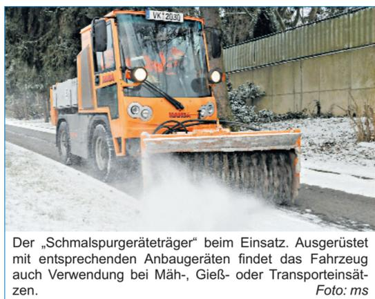
Der „Schmalspurgeräteträger“ beim Einsatz. Ausgerüstet mit entsprechenden Anbaugeräten findet das Fahrzeug auch Verwendung bei Mäh-, Gieß- oder Transporteinsätzen. Foto: ms
